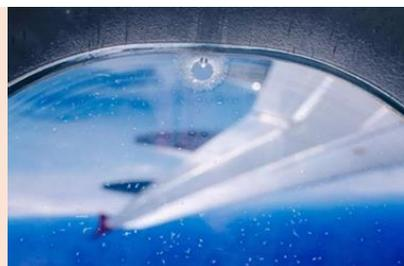
Отверстие в стекле, увиденное пассажиром во время полета, вполне может его испугать. Однако оно сделано специально, чтобы снять напряжение внутри стеклопакета. Такое регулирование давления воздуха предотвращает появление трещин на стеклах и разгерметизацию салона.
